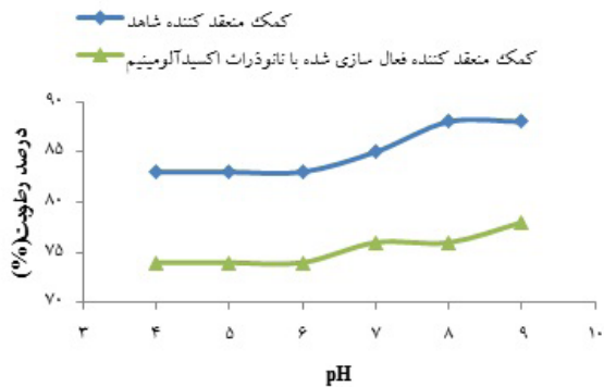
نمودار ۴: تأثیر pH بر کارایی فرآیند انعقاد (ب) درصد رطوبت کیک
