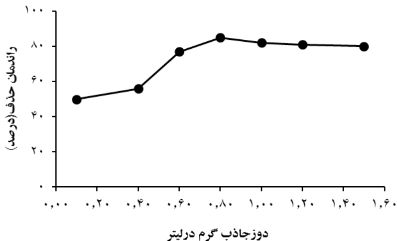
نمودار ۳: اثر دوز جاذب بر میزان حذف آنیلین با استفاده از خاکستر بادام کوهی (غلظت اولیه آنیلین ۱۰۰ میلی گرم بر لیتر؛ pH=۷؛ مدت زمان واکنش ۶۰ دقیقه)
