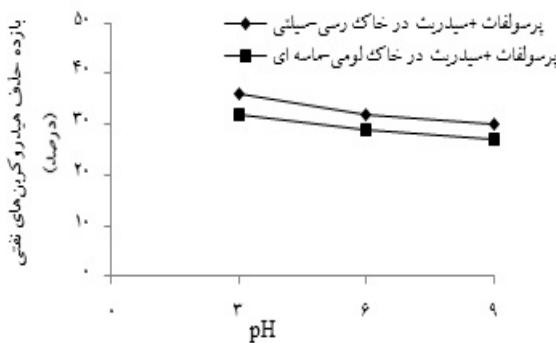
نمودار ۳: تأثیر pH بر اکسیدان پرسولفات در حذف هیدروکربن‌های نفتی با غلظت  $5000$  میلی گرم بر کیلوگرم، نسبت پرسولفات بهینه به سیدریت بهینه در خاک رسی-سیلیتی  $0/4$  گرم بر لیتر/ $400$  میلی مولار و لومی-ساسه‌ای  $0/3$  گرم بر لیتر/ $300$  میلی مولار در دمای  $20 \pm 1$  درجه سانتی‌گراد
