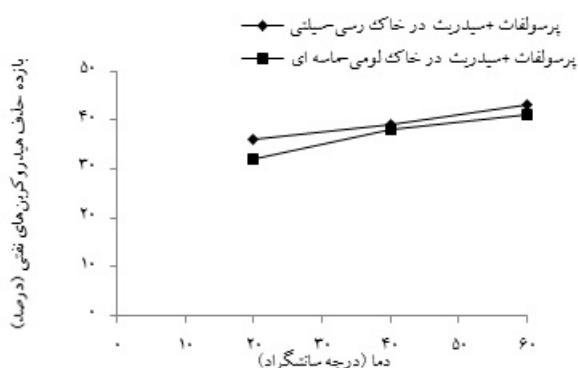
نمودار ۴: تأثیر دما بر اکسیدان پرسولفات در حذف هیدروکربن‌های نفتی با غلظت  $5000$  میلی گرم بر کیلوگرم، نسبت پرسولفات بهینه به سیدریت بهینه در خاک رسی-سیلیتی  $0/4$  گرم بر لیتر/ $400$  میلی مولار و لومی-ساسه‌ای  $0/3$  گرم بر لیتر/ $300$  میلی مولار pH:  $3$
