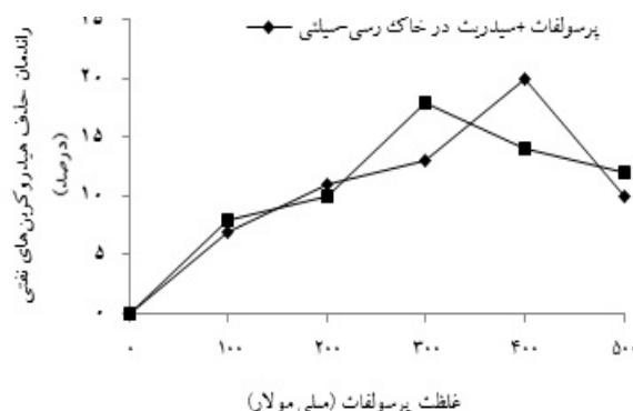
نمودار ۱: بازده حذف هیدروکربن‌های نفتی با غلظت  $5000$  میلی گرم بر کیلوگرم در غلظت‌های مختلف پرسولفات برای خاک رسی-سیلتی و لومی-ماسه‌ای در دمای  $20 \pm 1$  درجه سانتی‌گراد
