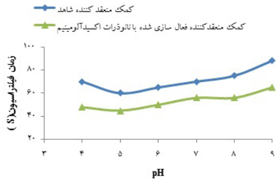
نمودار ۳: تأثیر pH بر کارایی فرآیند انعقاد (الف) مدت زمان فیلتراسیون (TTF)
